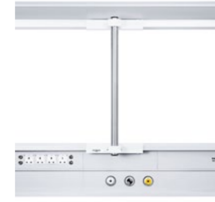
ZH 0150 GERÄTEWAGEN VS 100 EINZELROHR 1.000 MM LANG Gerätewagen für das Versorgungssystem VS 100 mit 1 Edelstahl-Tragrohr Ø 38 mm, 1.000 mm lang // Oben und unten mit Traverse für Geräteschiene 25 x 10 mm // Obere Traverse mechanisch gebremst // Gewicht 3,7 kg // Max. Belastung 75 kg Bestell-Nr. 449011
