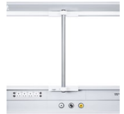
ZH 0130 GERÄTEWAGEN VS 100 EINZELROHR 1.300 MM LANG Gerätewagen für das Versorgungssystem VS 100 mit 1 Edelstahl-Tragrohr Ø 38 mm, 1.300 mm lang // Oben und unten mit Traverse für Geräteschiene 25 x 10 mm // Obere Traverse mechanisch gebremst // Gewicht 4,1 kg // Max. Belastung 75 kg Bestell-Nr. 448991
