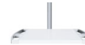
ZH 2270 KONSOLE SCHMAL Konsole mit Nutzfläche von 490 x 430 mm // RAL 9002 // Mit seitlichen Geräteschienen 25 x 10 mm // Zur Montage an 1 Rohr Ø 38 mm // Gewicht 10,9 kg // Max. Belastung Konsole mit Nutzfläche 40 kg // Max. Belastung je Geräteschiene 10 kg Bestell-Nr. 10080761
